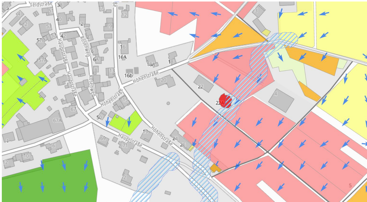
Abbildung: Fließpfade (schraffiert), Fließrichtung (Pfeile), Hangneigung (Farben), betroffene Einzelgebäude (rot) Quelle: Starkregenviewer Hessen [HLNUG]
